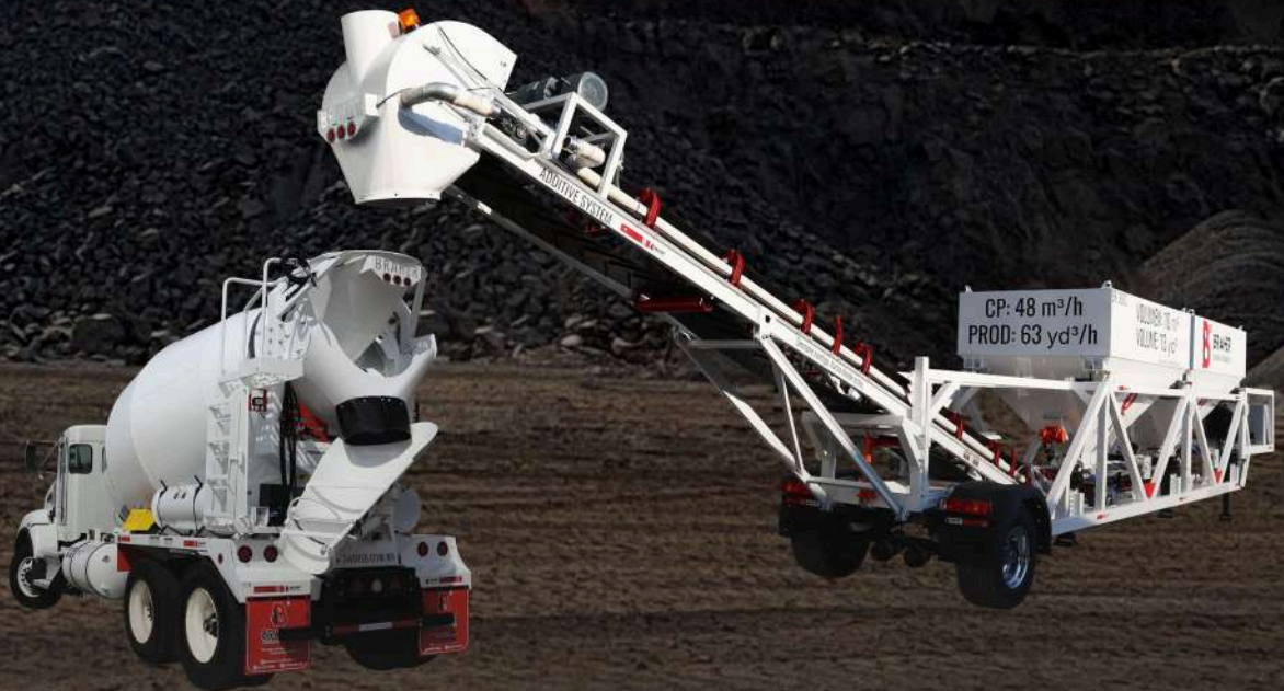
Silo de 60 toneladas + Planta dosificadora de 3 tolvas
