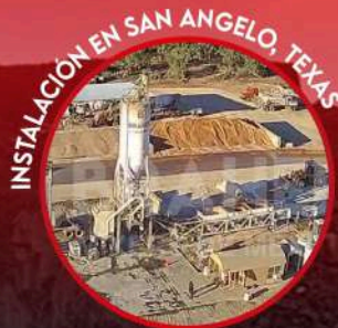
Silo de 60 toneladas + Planta dosificadora de 3 tolvas
