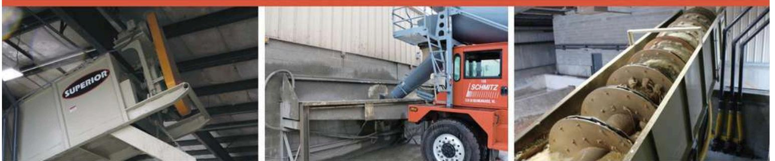
El sistema de lavado de hormigón de Superior recupera la arena y la grava sobrantes de los bidones de los camiones de premezclado. Una boquilla de alta presión arrastra los materiales a una lavadora, donde la arena y la grava se separan para su reutilización, y el agua también se puede reciclar.
