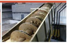
El sistema de lavado de hormigón de Superior recupera la arena y la grava sobrantes de los bidones de los camiones de premezclado. Una boquilla de alta presión arrastra los materiales a una lavadora, donde la arena y la grava se separan para su reutilización, y el agua también se puede reciclar.
