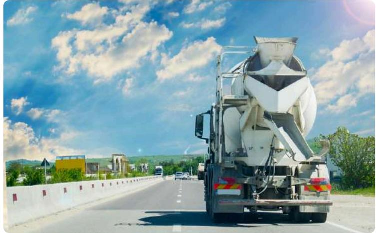
La popularización del concreto premezclado impulsó el crecimiento de este tipo de vehículos. Según la Portland Cement Association, la necesidad de concretos de alta calidad y de mezclas más homogéneas provocó que el camión revolvedor se convirtiera en el medio estándar para el suministro de concreto en obras de todo tipo (Cement.org, s.f.). A partir de 1940, estos camiones fueron imprescindibles para las grandes obras de infraestructura, impulsando su evolución tecnológica.
