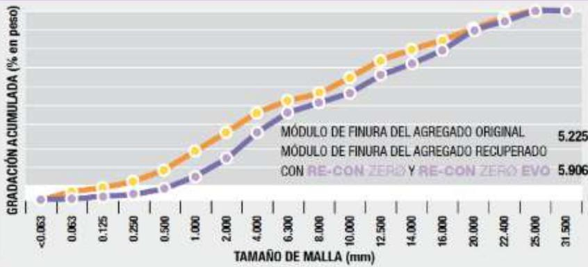
Agregados recuperados con **RE-CON ZERO** Y **RE-CON ZERO EVO** en conformidad con la norma EN 12620:2008
